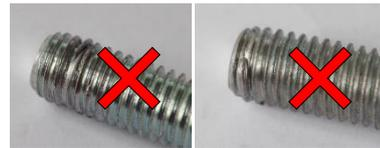
Bild 5 beschädigte M10-Schrauben
